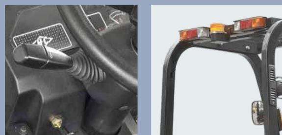
Гидротрансформатор оснащён соленоидными клапанами для переключения направления хода, что снизило усилия при выполнении этой часто используемой функции.
