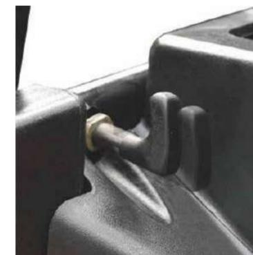
Зазор между рулевым мостом и упором на противовесе может регулироваться для адаптации к состоянию пола.
